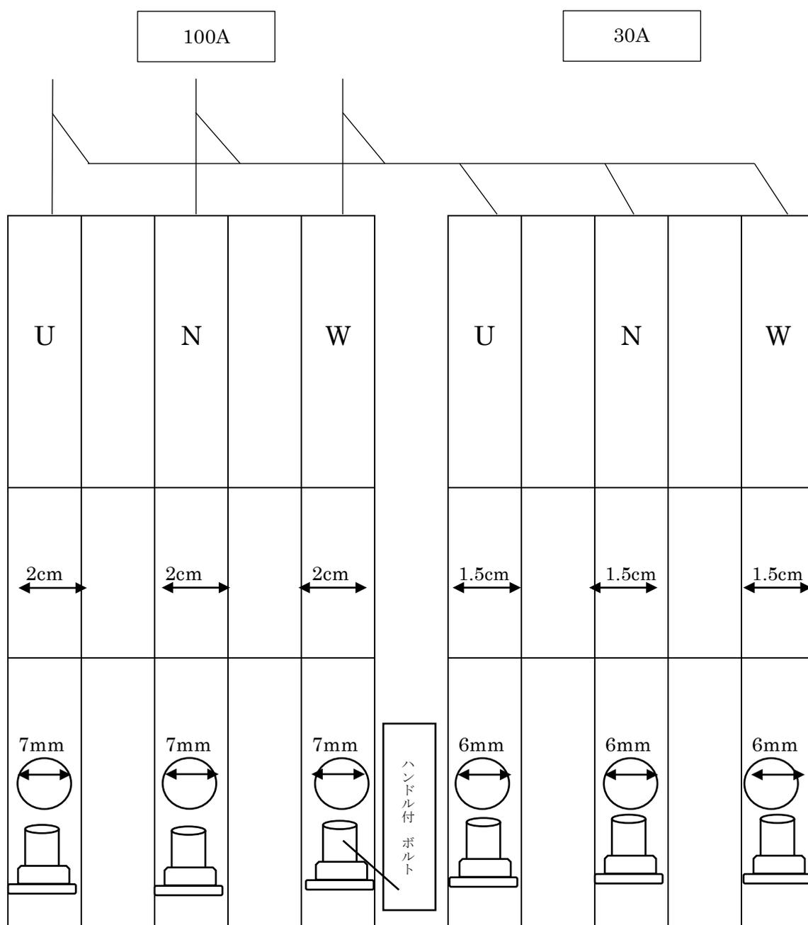
\* 端子盤の下から端子を入れ、ハンドル付ボルトで締め付けるタイプ。
