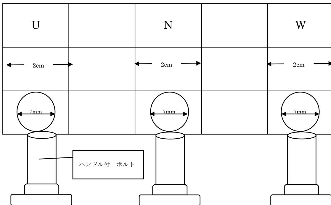
\* 端子盤の下から端子を入れ、ハンドル付ボルトで締め付けるタイプ。
